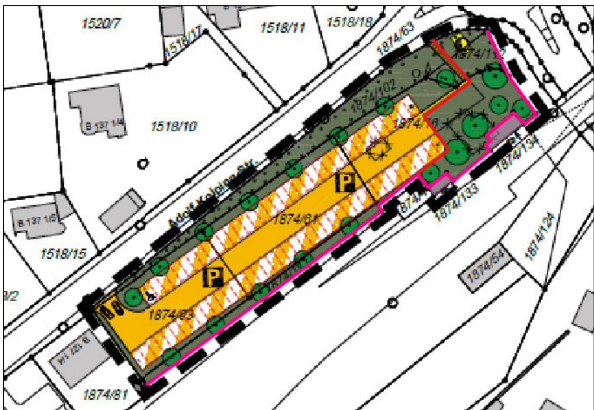
Abbildung 4: Planungsgebiet mit dem temporären Reptilienschutzzaun (pinke Linie) und der Trockenmauer bzw. Handlauf (rote Linie). Der temporäre Zaun ist bis nach Fertigstellung des Parkplatzes stehen zu lassen und regelmäßig auf seine Funktionalität zu überprüfen.
