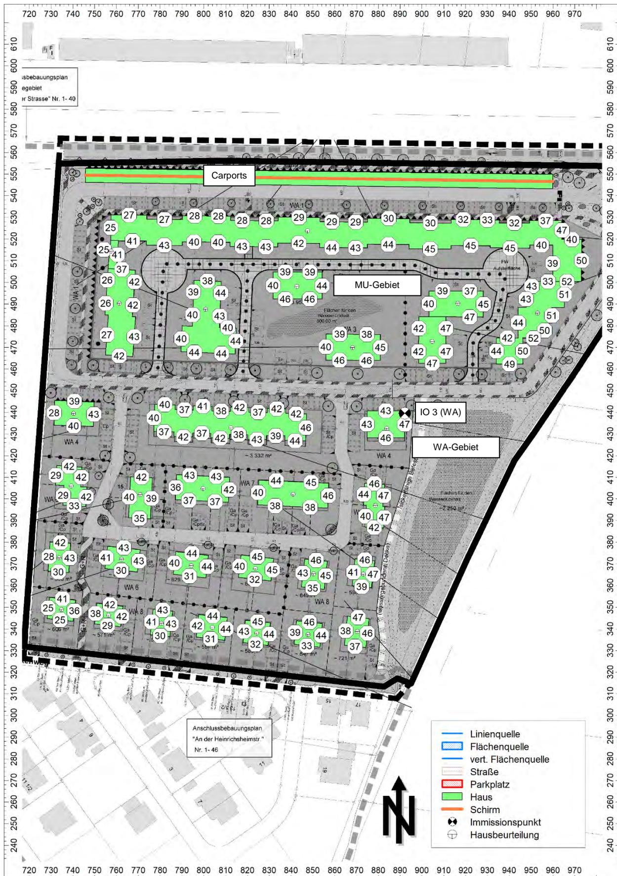
Passive Schallschutzmaßnahmen gegen Verkehrsgeräusche nach DIN 4109
