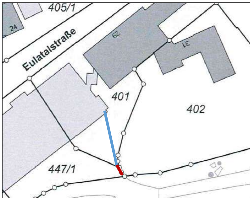
Abb. 1: Lageplan mit Darstellung einer geeigneten Lärmschutzwand
