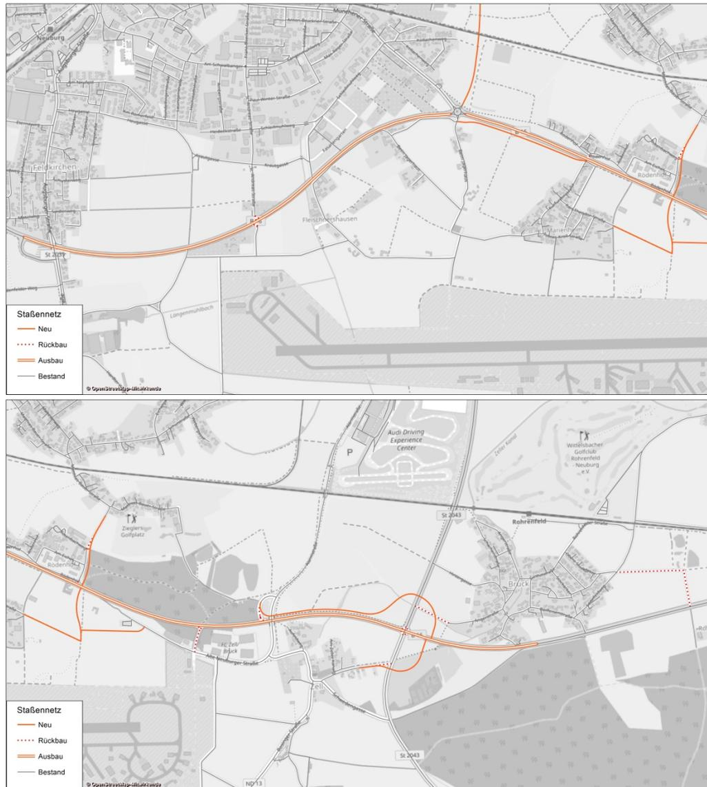
**Abbildung 2: Übersicht des Verlaufs der Variante 1 "4-streifiger Ausbau der B16 bis zum Kreisverkehr mit höhenfreier Zeller Kreuzung" (Abbildung oben Abschnitt West und unten Abschnitt Ost)**
